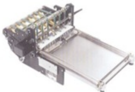
Sortie verticale KS 310 pour pli miniature.
