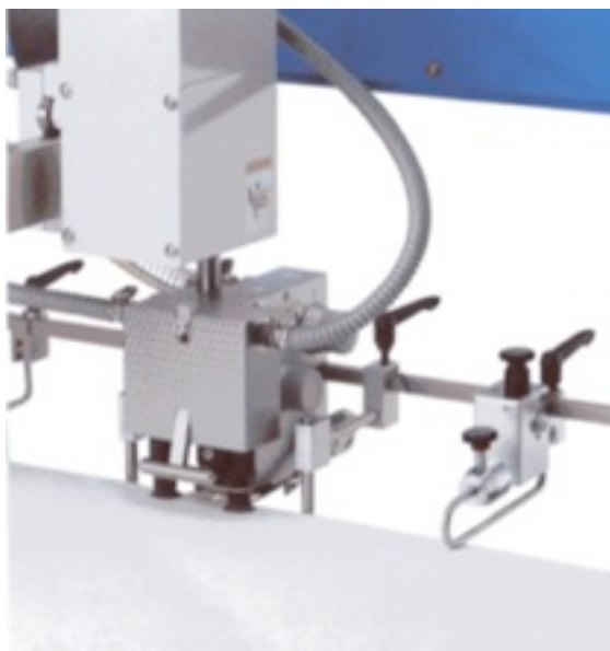
Réglage électronique de la hauteur de la tête de séparation arrière
