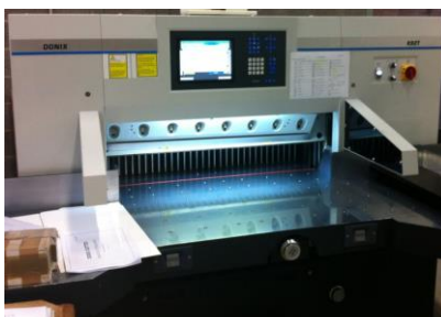
Equerre en fonte à double guidage / Plan de travail éclairé et ligne de coupe lumineuse / Capots arrières
